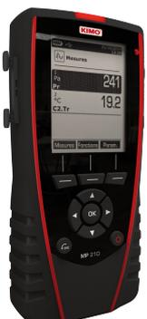
**MP 210 H** : MP 210 + module de pression MPR 500 M (module de pression  $\pm 500$  mbar)
